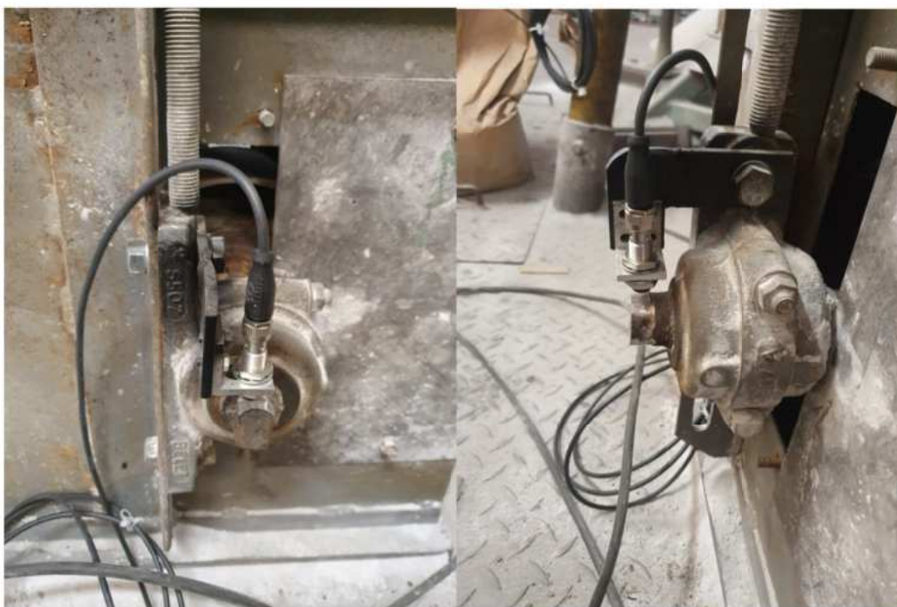
Obrázek 4: Umístění čidla na elevátoru
